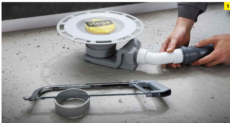
Odvodna garnitura modela 4927 lako se čisti i ima prilagodljivo priključno koljeno za priključnu cijev prema odabiru, od 40 ili 50 mm.
