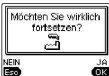
*Vor der Durchführung der einzelnen oben angeführten Befehle verlangt der Regler die Bestätigung des Befehls.*
