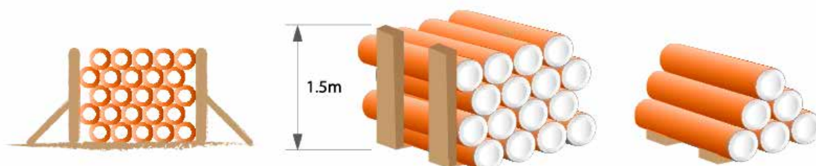
Slika br.11: PVC STRONG cevi pravilno položene na drvene gredice
