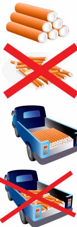
Slika br.7: Izgled pravilno i ne pravilno složenih cevi prilikom transporta
