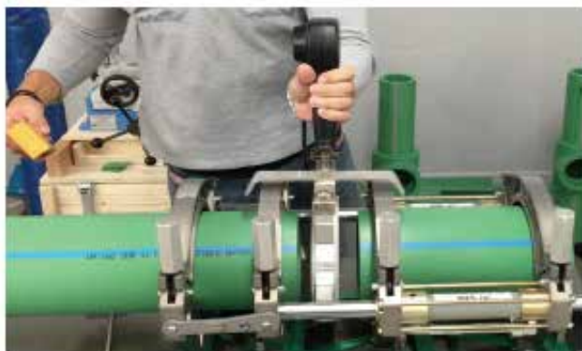
Slika br. 43: Insertacija grejne ploče
