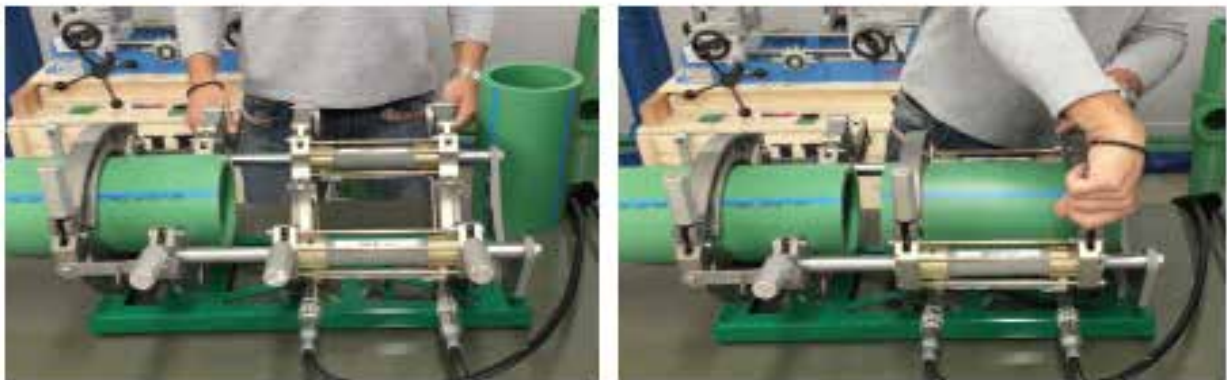
Slika br. 41: Fiksiranje cevi čeljustima
