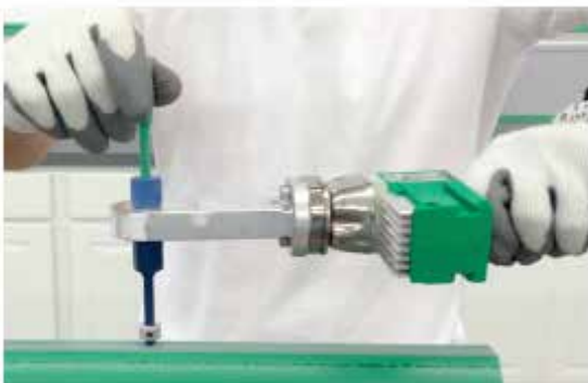
Slika br. 47: Insertacija alata za reparaciju
