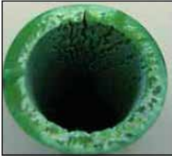
Slika br. 53: Izgled degradirane PP-R i PP-RCT cevi usled delovanja negativnih jona bakra
