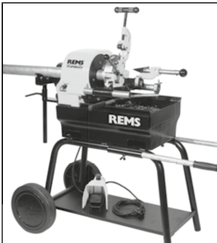
Fig. 7: REMS Tornado mit Ölwanne und Untergestell Fig. 7: REMS Tornado with oil tray and wheel stand Fig. 7: REMS Tornado avec bac à huile et support Fig. 7: REMS Tornado con vasca dell'olio e piedistallo Fig. 7: REMS Tornado con bandeja de aceite y bastidor Fig. 7: REMS Tornado met oliebak en onderstel Fig. 7: REMS Tornado med oljetråg och stativ Fig. 7: REMS Tornado med oljepanne og understell Fig. 7: REMS Tornado med oliekar og understell Kuva 7: REMS Tornado, sis. öljyaltaan ja alustan Fig. 7: REMS Tornado com cârter do óleo e subestrutura Rys. 7: REMS Tornado z miską olejową i podstawą Obr. 7: REMS Tornado olejovou vanou a podstavcem Obr. 7: REMS Tornado olejovou vanou a podstavcom 7. ábra: REMS Tornado olajteknővel és állványal Sl. 7: REMS Tornado s koritom za ulje i postoljem Sl. 7: REMS Tornado sa koritom za ulje i postoljem Slika 7: REMS Tornado s oljno kadjio in podstavkom Fig. 7: REMS Tornado cu vană de ulei și suport Фиг. 7: REMS Торнадо с масляным поддоном и подставкой Eik. 7: REMS Tornado με ελασιολεκάκι και βάση Resim 7: REMS Tornado, yağ teknesi ve sehpayla birlikte Фиг. 7: REMS Торнадо с маслена ваиа и стойка 7 pav.: REMS Tornado su alyvos vonelėir pastovu Att. 7: REMS Tornado ar eļļas vannu un apakštatni Joonis 7: REMS Tornado õlivanni ja alusraamiga
