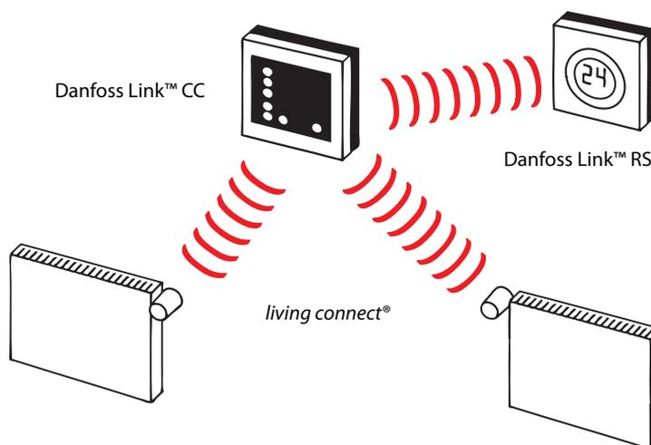
Postavljena temperatura može se promijeniti na termostatu *living connect*<sup>®</sup> pomoću tri tipke ili na regulatoru Danfoss Link<sup>™</sup> CC.
