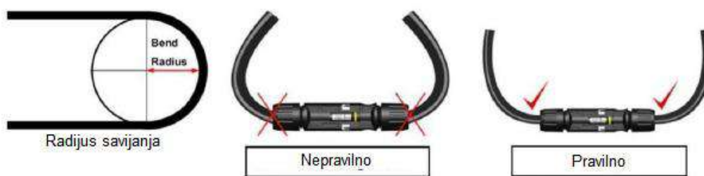
Slika 5. Pravilno polaganje i najmanji radijus savijanja.
