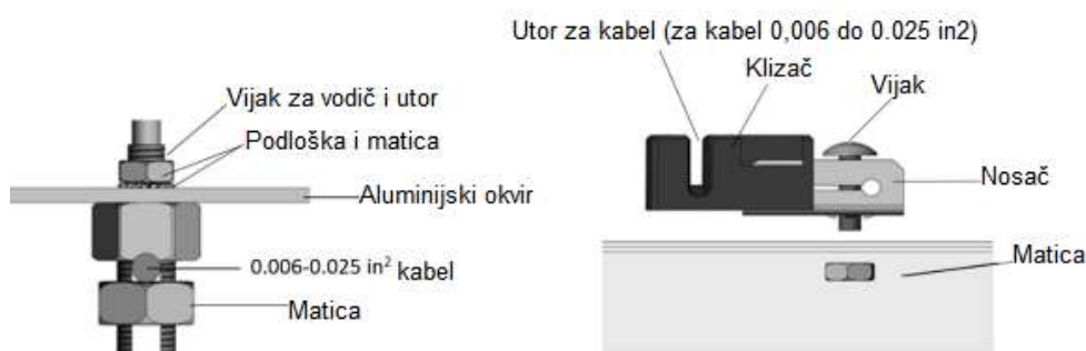
Slika 4. Načini uzemljenja fotonaponskog modula (norma IEC)
