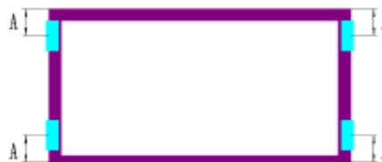
Koristite 4 spojnice na kratkoj strani.
