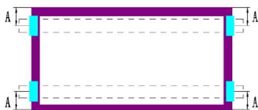
Koristite 4 spojnice na kratkoj strani. Profil za ugradnju paralelan je s dugom stranom okvira.
