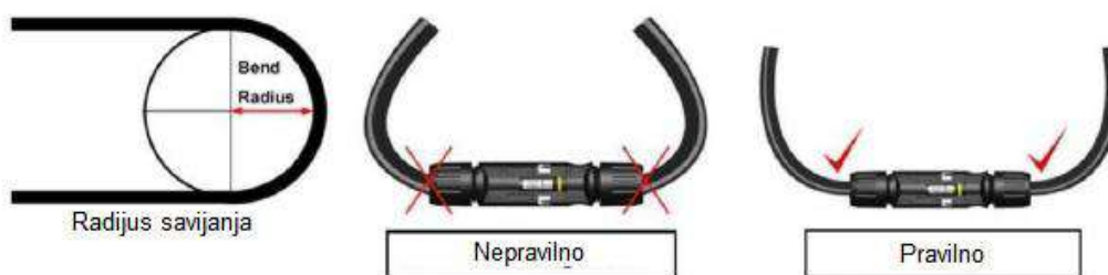
Slika 5. Pravilno polaganje i najmanji radijus savijanja.
