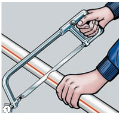
1 Skinite izolaciju s Prestabo cijevi te je skratite pilom s finim zubima pod pravim kutom.
